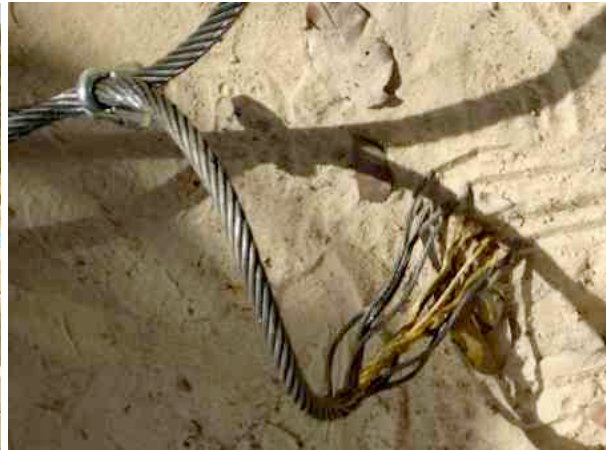
Die 15mm Stahlseile halten nicht stand
