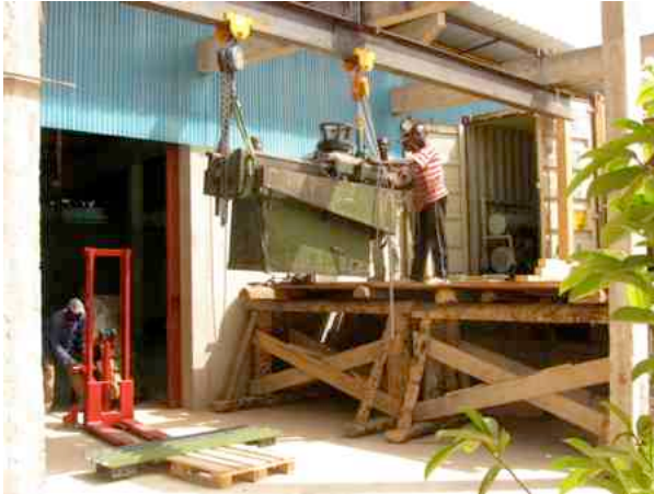
Entladen der Schürfmachine für Hobelmesser
