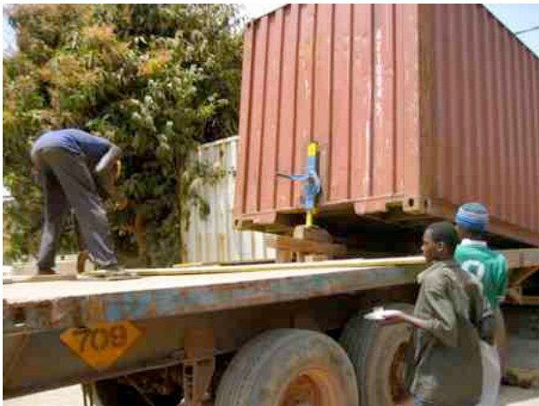
Der Container bleibt an seinen Querträgern am Boden hängen
